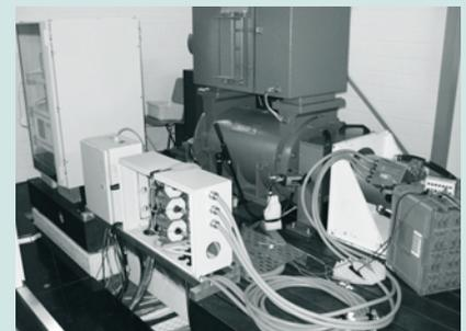
Prüfstände für Permanentmagnet-Synchronmotoren für Elektrofahrzeuge
