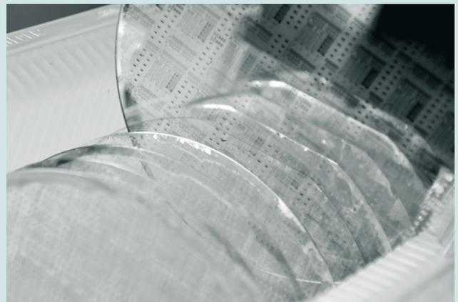
Transparente Feldeffekt-Transistoren aus nanopartikulärem Zinkoxid auf Glassubstrat
