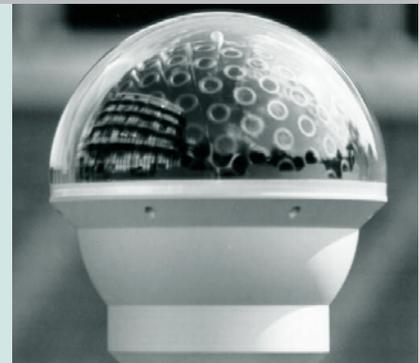
In der Arbeitsgruppe entwickeltes Messgerät für solare Einstrahlung zur spatialen Erfassung der Himmelsbestrahlungsstärke
