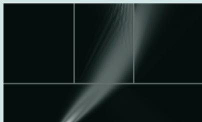
Simulation der Einkopplung eines Gaußschen Lichtstrahls in einen Lichtwellenleiter
