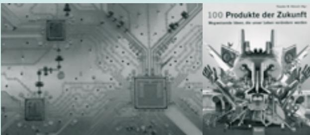
SiGe-Analog-Digital-Wandler und ein CMOS-Signalverarbeitungsbaustein auf einer Keramikleiterplatte (links) für synchrone optische QPSK-Datenübertragung mit Polarisationsmultiplex mit 10 Gb/s ([ont.upb.de/synQPSK](http://ont.upb.de/synQPSK)) – laut Nobelpreisträger Theodor Hänsch eines der „100 Produkte der Zukunft“ (rechts)
