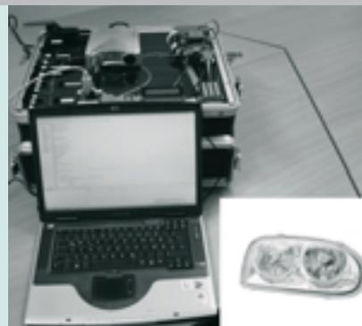
Simulationsstand für einen Winkelsensor mit integriertem Steuergerät zur automatischen Leuchtweitenregelung von Kfz-Scheinwerfern
