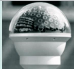
In der Arbeitsgruppe entwickeltes Messgerät für solare Einstrahlung
