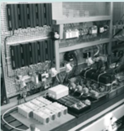
Prüfstand zum hybriden Energiespeichersystem
