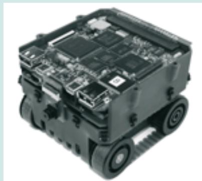
Miniroboter BeBot mit Mobilprozessor, FPGA- und Kameramodul
