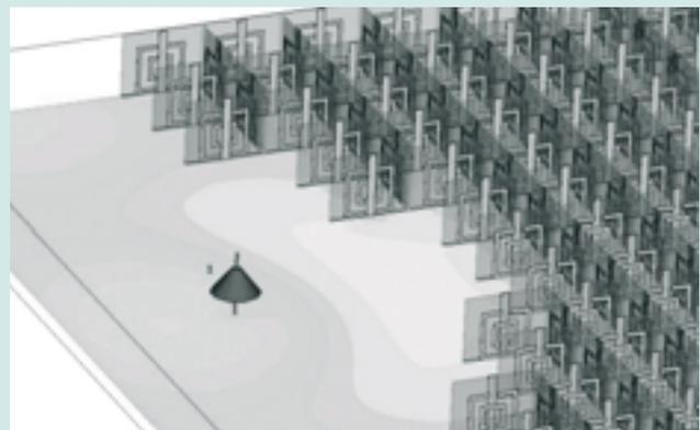
Studie einer elektromagnetischen Linse aus einem Metamaterial mit negativer Brechzahl
